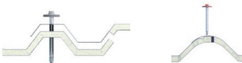
Pormenores da sobreposição transversal das chapas metálicas compósitas Chapa Térmica IsoTec27 (esq.) e Telha Térmica IsoTecCoppo (dir.)
